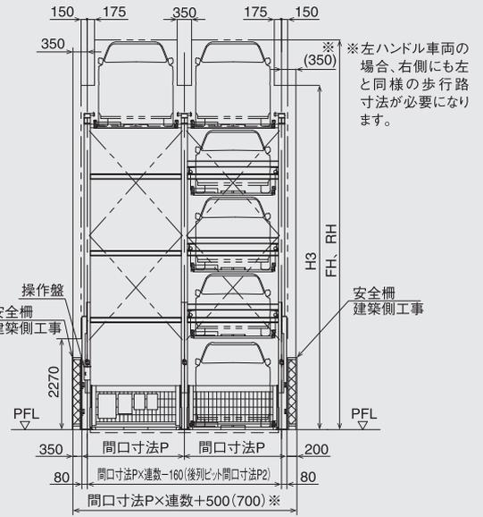
注1) 本図は各パレットの定位状態を示し、通常の状態では昇降するパレットのいずれかが乗込み位置にある場合があります。
