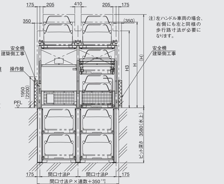
注1) 本図は各パレットの定位置状態を示し、通常の状態では昇降するパレットのいずれかが乗込み位置にあります。
