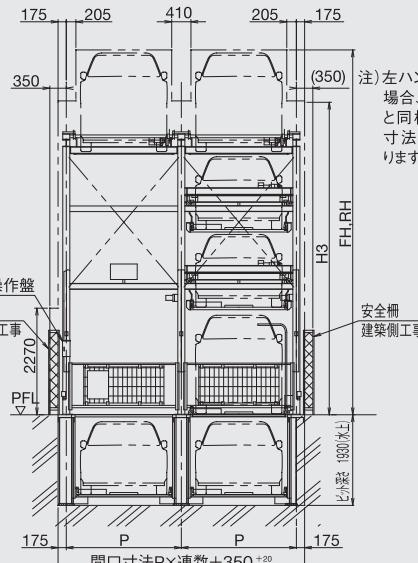
注1)本図は各パレットの定位位置状態を示し、通常の状態ではパレットのいずれかが乗込み位置にあります。
